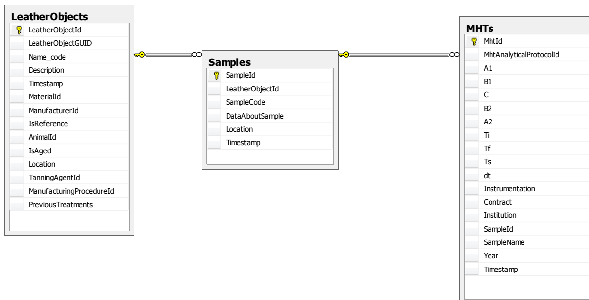
Figura 12. Schema bazei de date a sistemului automat imageMHT
